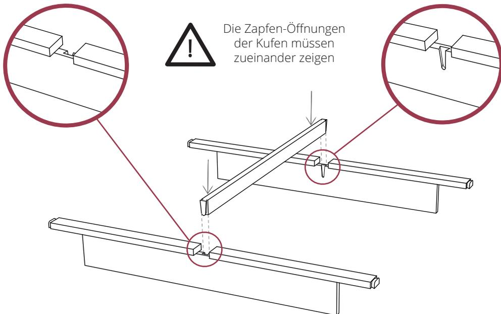
Die Längszarge oben bündig einschlagen
