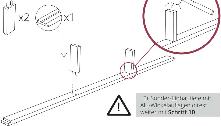
**8** Nur bei Bettbreiten ab 140 cm mit 2 Lattenrosten: Die Mittelauflage-Halterungen für die entsprechende Einbautiefe in Kopf- und Fußteil einklopfen, die Mittelaufgabe auflegen und die Feder in die Nut einstecken
